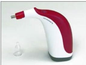
Insertar la punta de medición en la tapa de protección contra infecciones
