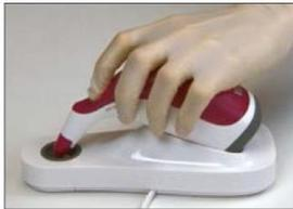
Colocar VITA Easyshade V en la estación de base y pulsar el botón de medición para calibrar
