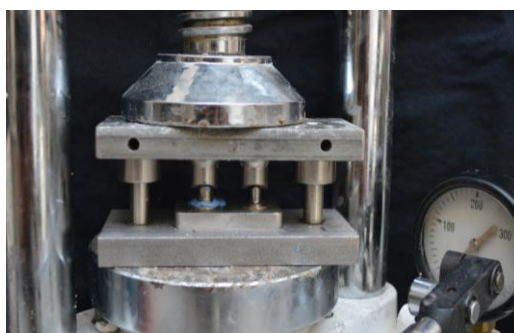
Figura 11 Aplicación de silicona en la matriz de acero Prensa hidráulica Mestra (España) 10 bs de presión
