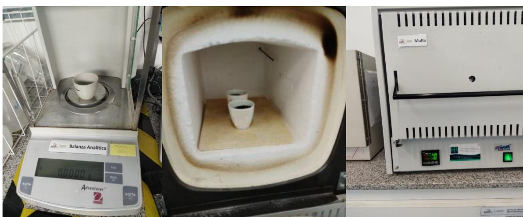
Figura 6. Activación física del carbón activado y zeolita. Este apartado muestra el proceso de activación física del carbón activado y zeolita con el uso de materiales de laboratorio.
