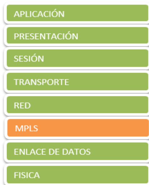
Figura 1. Modelo OSI que incluye el protocolo MPLS.
