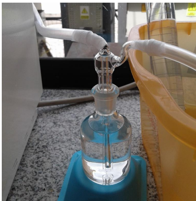
Anexo 6: Frascos lavadores con NaOH para la obtención de metano.
