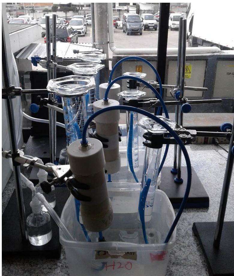
Anexo 6: Frascos lavadores con NaOH para la obtención de metano.
