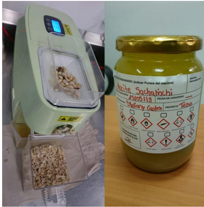
Figura 4. Obtención del aceite Sacha Inchi por el método tornillo sin fin.
