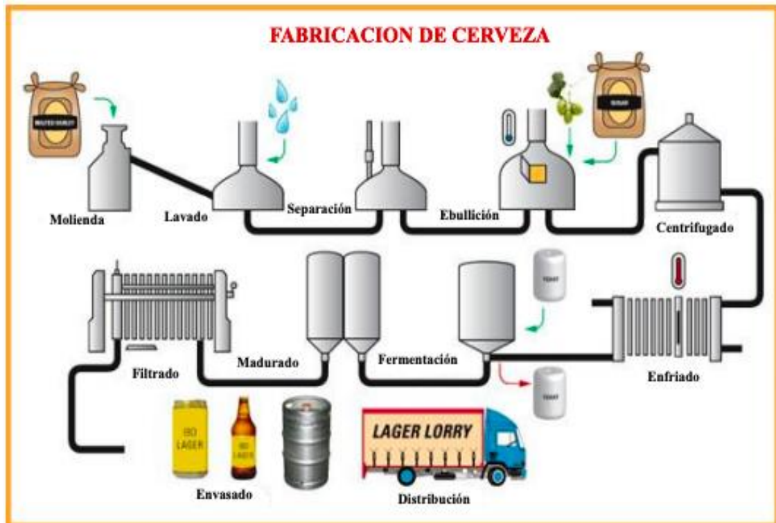
Figura 6. Proceso de elaboración de cerveza
