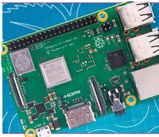
*Figura 1.* Estructura Raspberry pi.
