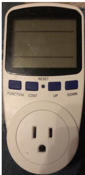
Figura 8 Medidor de consumo eléctrico
