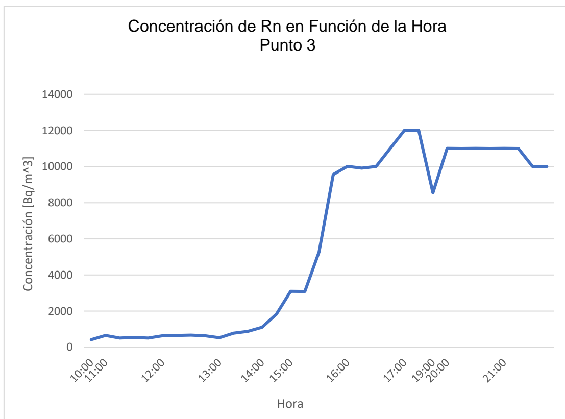
Figura 28. Concentración de radón en función de la hora en el P3
