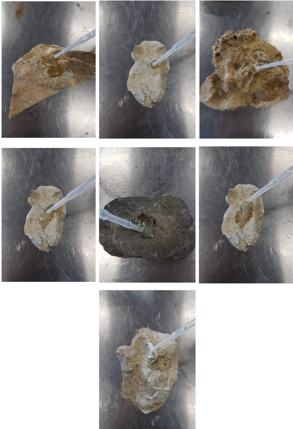
Figura 17. Serie de pruebas realizadas con HCl en diferentes rocas
