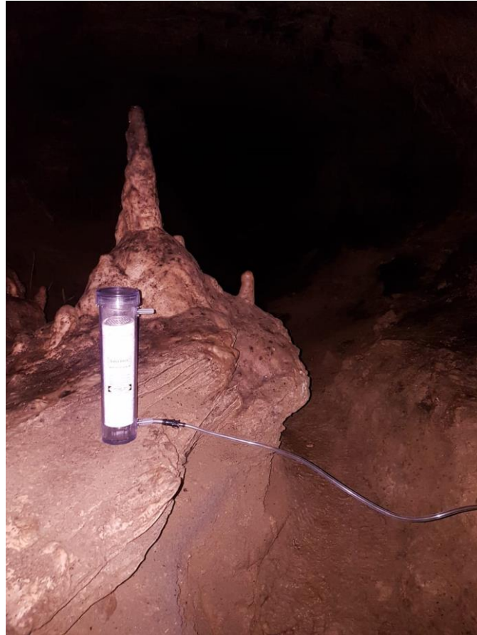
Anexo 15. Unidad de secado en posición al interior de la cámara 2 de la cueva USA YAKU
