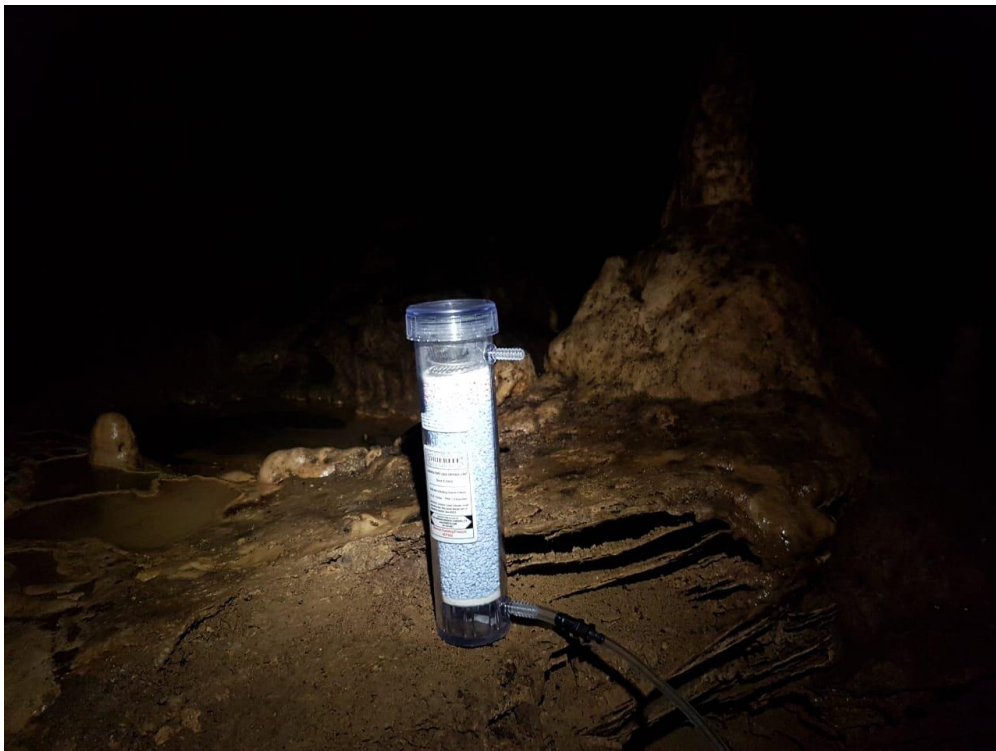
Anexo 11. Unidad de secado ubicada en punto de medición – Cueva USA YAKU
