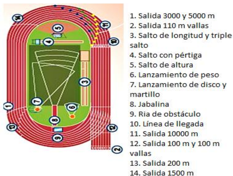
Figura 6 Estructura de una cancha de atletismo Tomado de: Marcano (2014)
