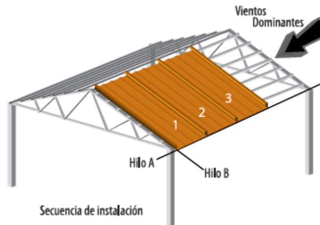
Figura 91. Secuencia de montaje. Tomado de: ACESCO COLOMBIA. Cubiertas industriales. Teja sin traslapo
