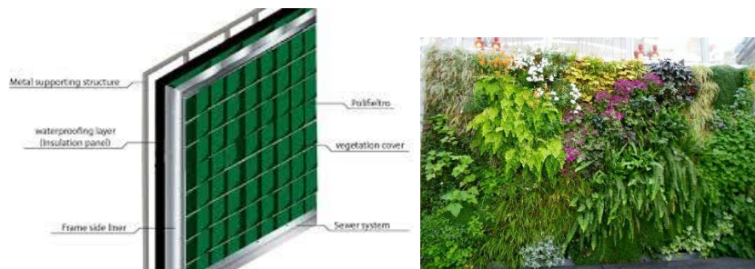
Figura N° 2: Estructura base (esqueleto) y producto final
