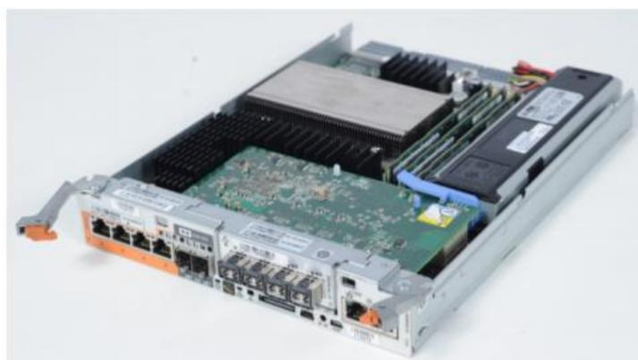
*Figura 20.* Procesador de almacenamiento (Parte superior extraída).
