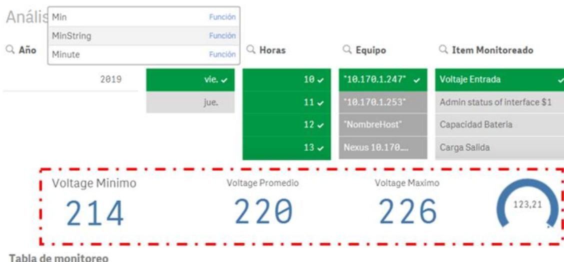
Figura 65. Valores del voltaje de entrada UPS.
