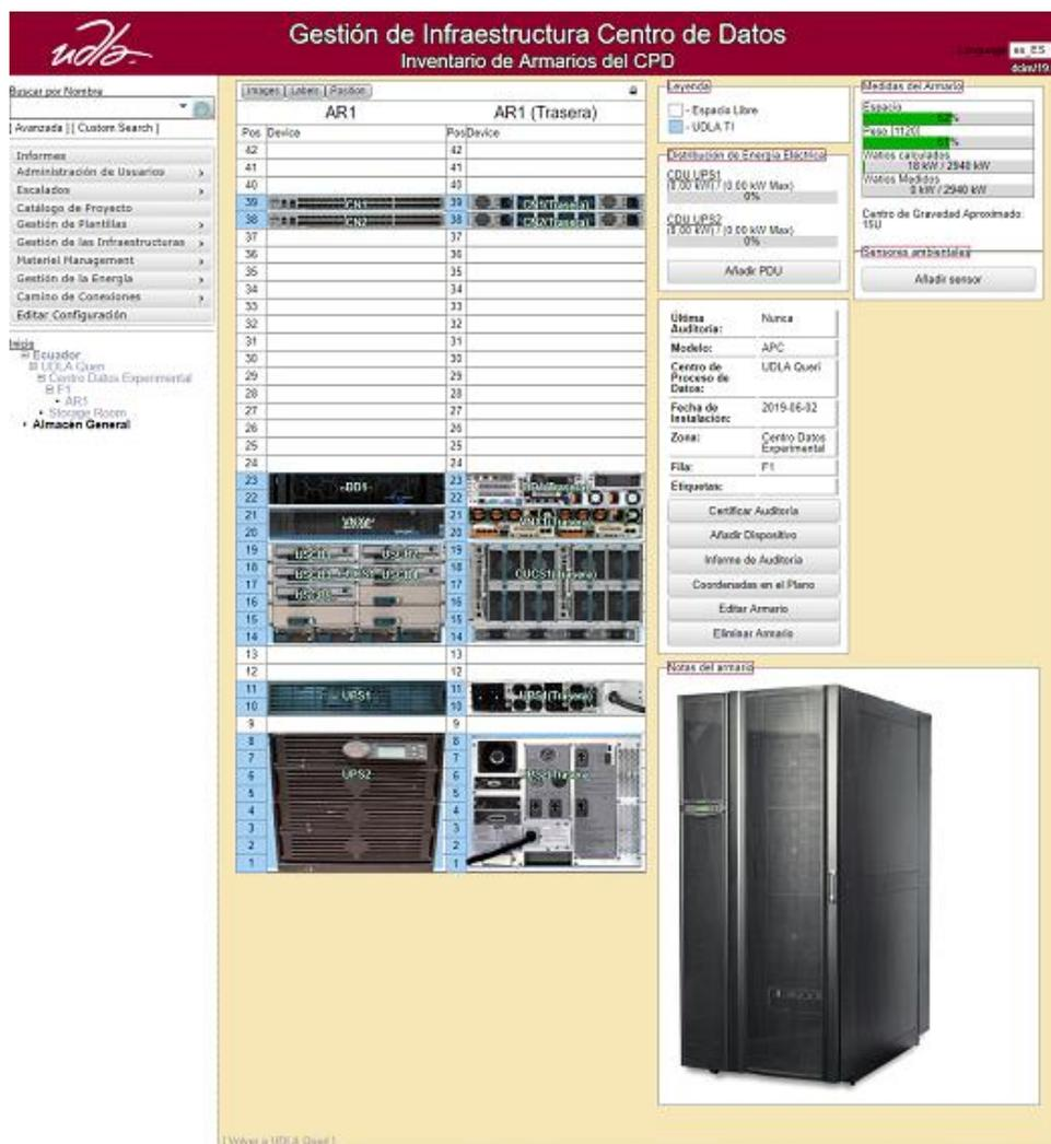
Figura 78. Plantilla con toda la infraestructura del centro de datos experimental. Tomado de (OpenDCIM, 2019)
