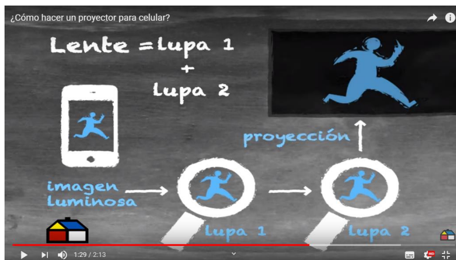
Figura 199. Funcionamiento de un proyector casero.
