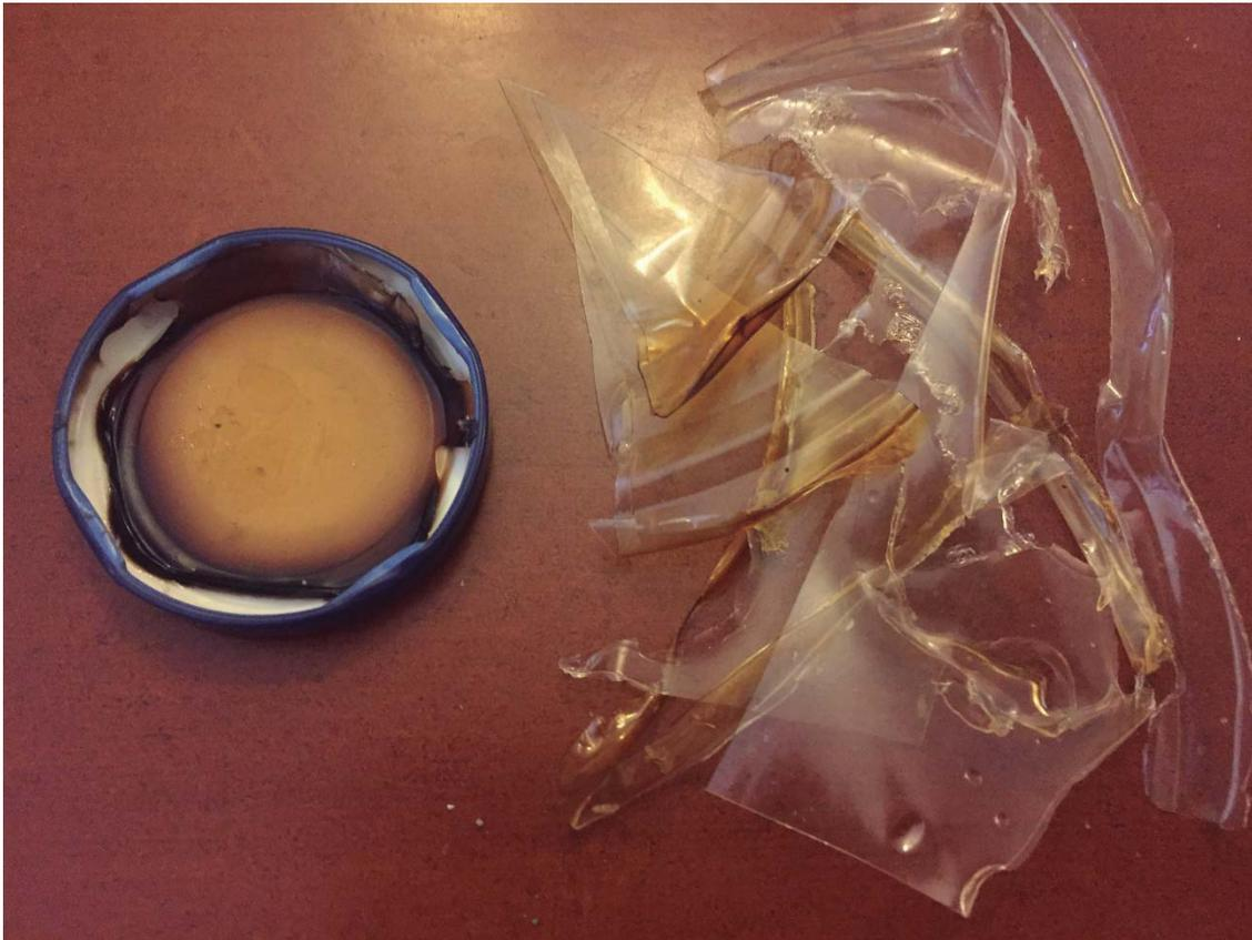
*Figura 55. (Izq.) Plástico comestible e hidrosoluble con electrolitos y vitamina c; (der.) plástico comestible e hidrosoluble*
