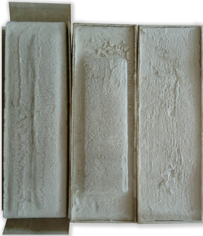
Figura 57. Prototipos de cemento con cajas de resonancia internas.
