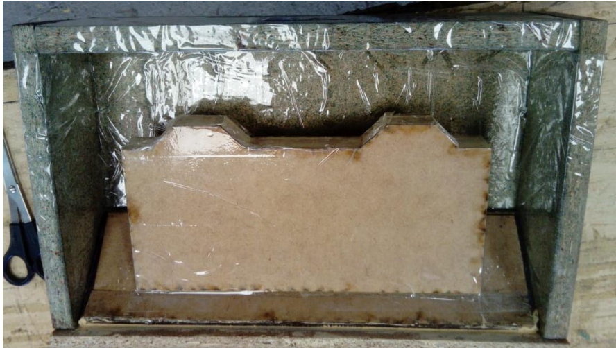
Figura 79. Molde listo para la aplicación de resina.
