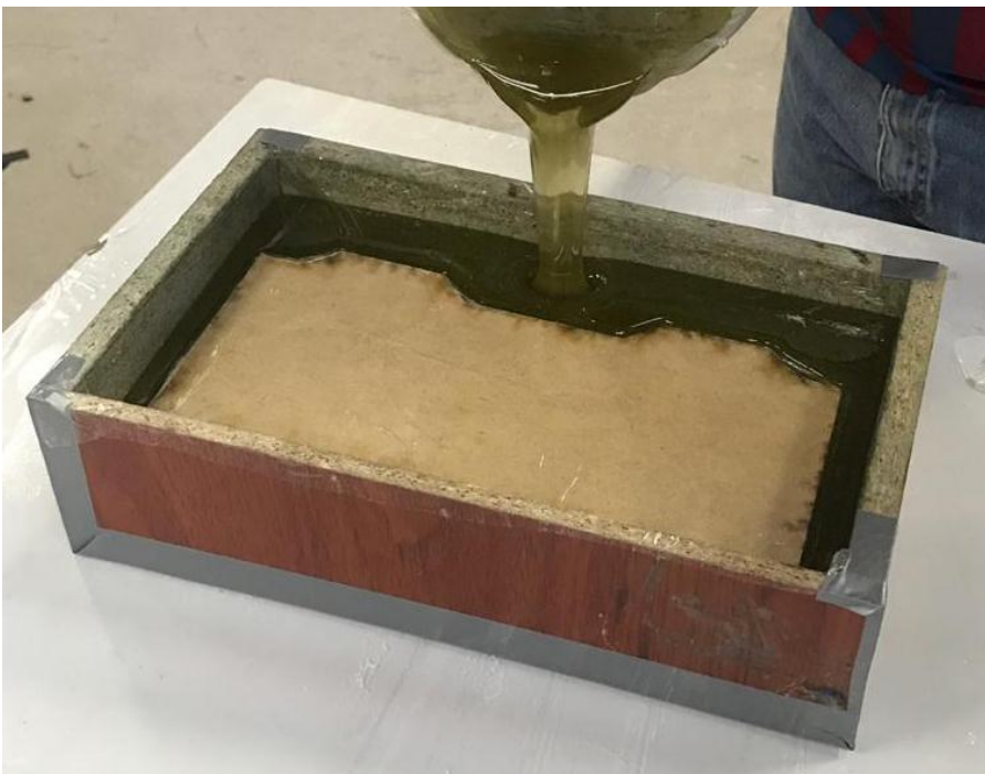
Figura 80. Aplicación de resina en el molde.
