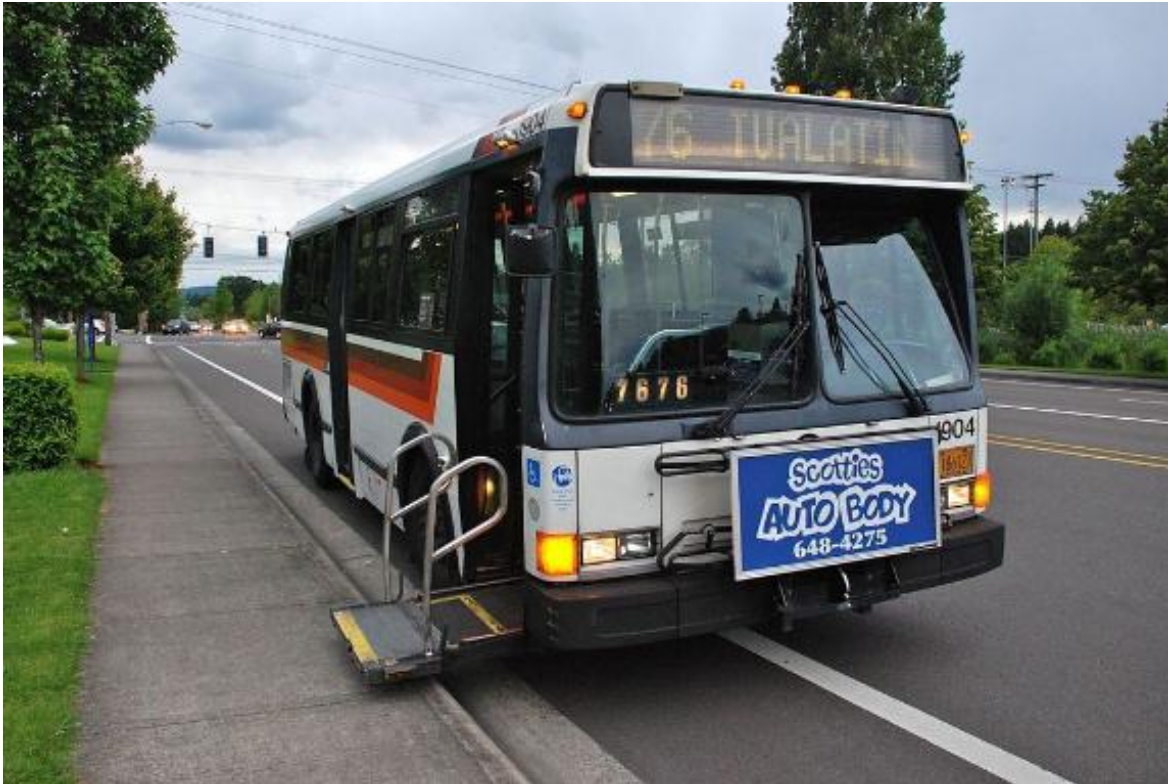
Figura 7. Bus con rampa móvil.
