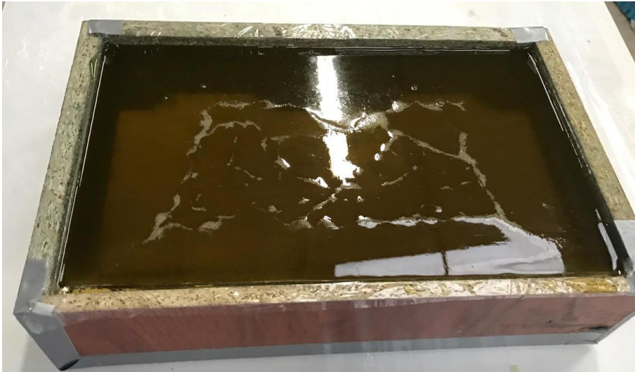
Figura 79. Resina vertida en el molde.
