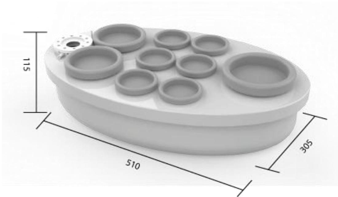
*Figura 64.* Diagrama de medidas generales prototipo final.
