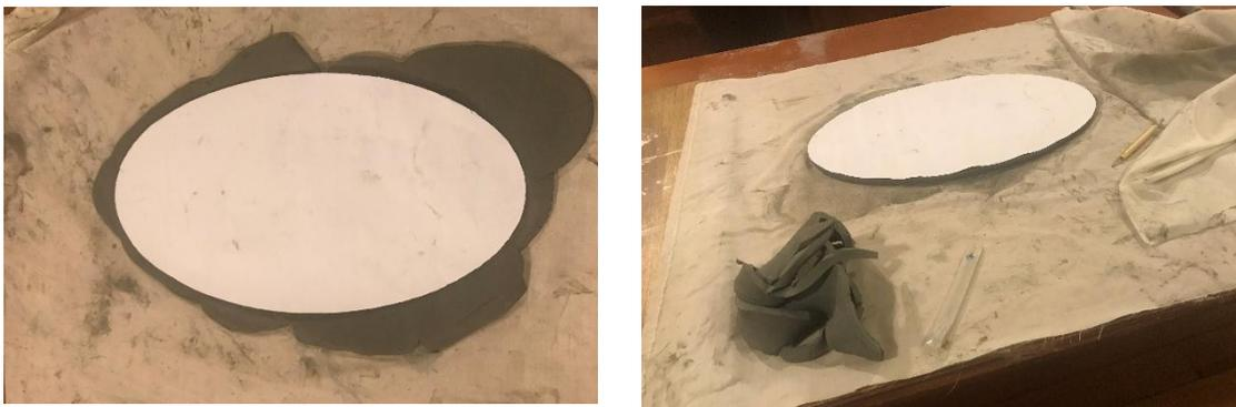
*Figura 70.* Corte de arcilla a medida de la pieza cuerpo.
