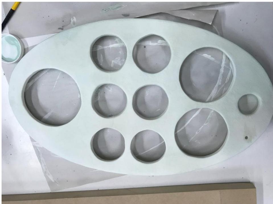
*Figura 74.* Pieza tapa esmaltada y lista para ser quemada.
