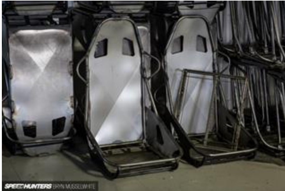
Figura 22. Estructura interna de asientos COBRA.
