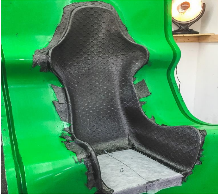
Figura 99. Imagen referencial. Aplicación de fibra de carbono al molde.
