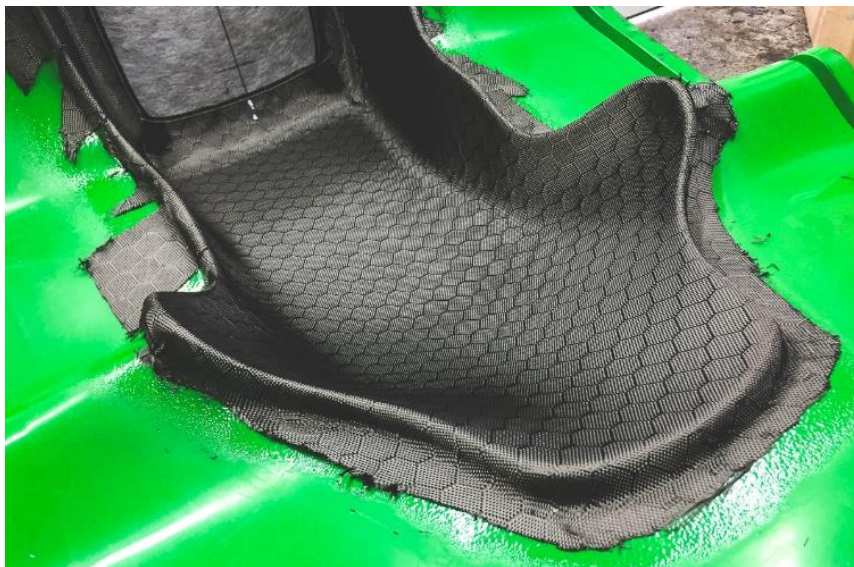
Figura 100. Imagen referencial. Recorte de excedente de fibra de carbono del molde.
