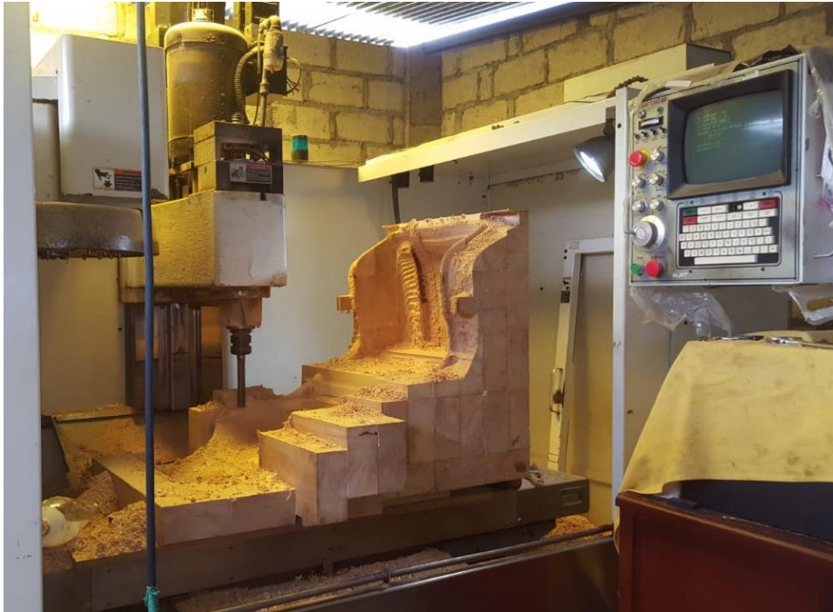
Figura 115. Desbaste de molde utilizando CNC de seis ejes.
