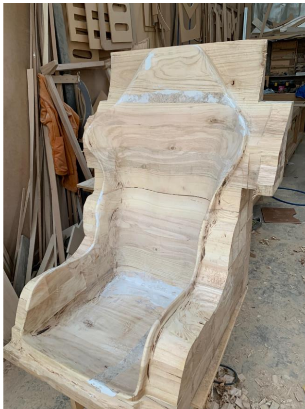
Figura 116. Molde de madera terminado.
