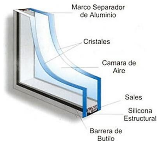
Figura 7. Sistema de doble vidrio hermético.
