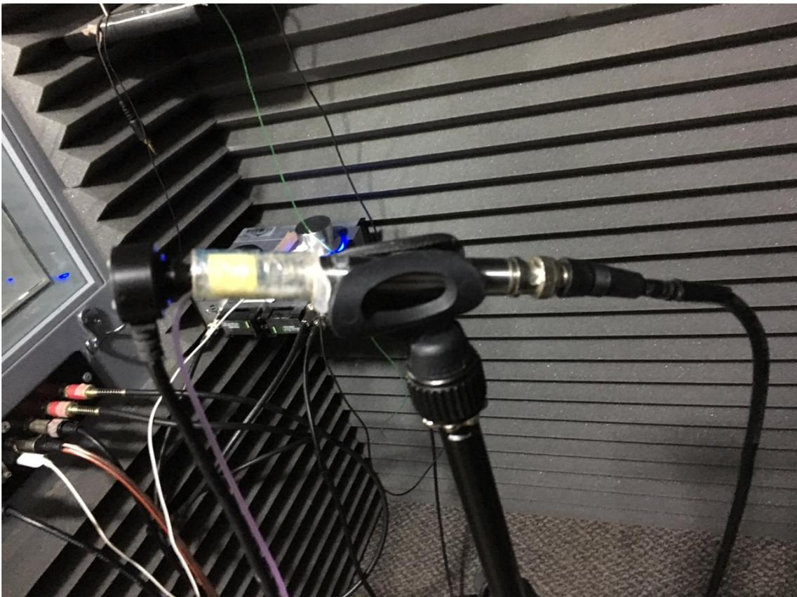
*Figura 23.* Calibración del sistema utilizando Etymotic y G.R.A.S montados a través de la adaptación de jeringa.
