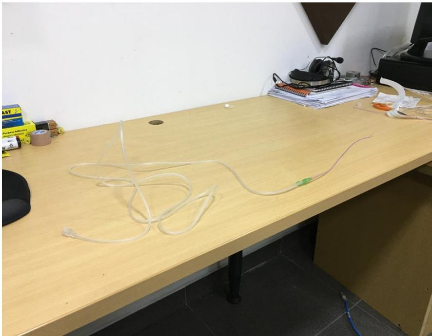
*Figura 28.* Sistema de sondas montado, una sonda pequeña unida a una sonda más ancha esta vez más larga, que encaja perfectamente con las tapas de jeringa insertada en el orificio del acrílico.
