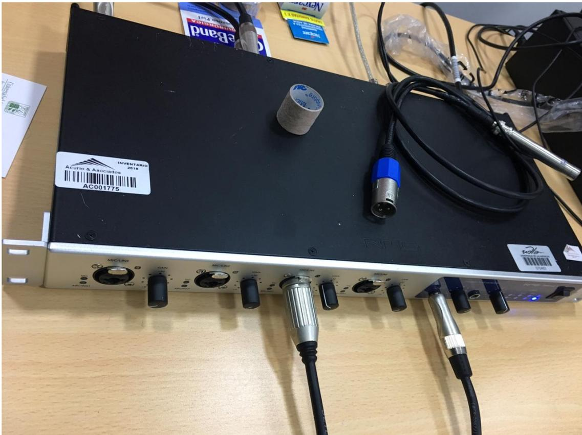
*Figura 24.* Conexiones de entrada y salida de la Interfaz FireFace. La de la izquierda es la entrada del micrófono G.R.A.S, y la de la derecha es la salida para el altavoz.
