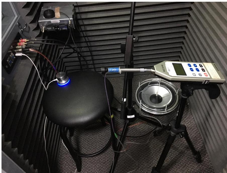
*Figura 29.* Medición y comprobación de la respuesta en frecuencia del nuevo sistema de subwoofer, con la utilización del sonómetro 01 dB DUO.
