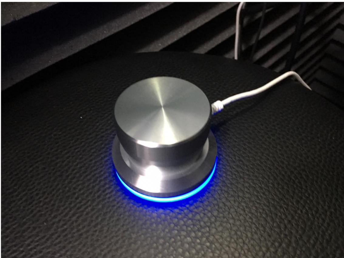
*Figura 19.* PowerMate USB, dispositivo por el cual se respondió a los estímulos del método de ajuste de la prueba.
