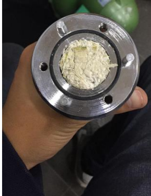
Figura 54. Colocación ideal de las muestras en el adaptador de tubo de impedancia, "Porta muestras".
