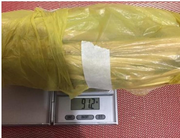
Figura 65. Fibra expuesta al horno doméstico, resultado de 91.2 gramos de reducción.
