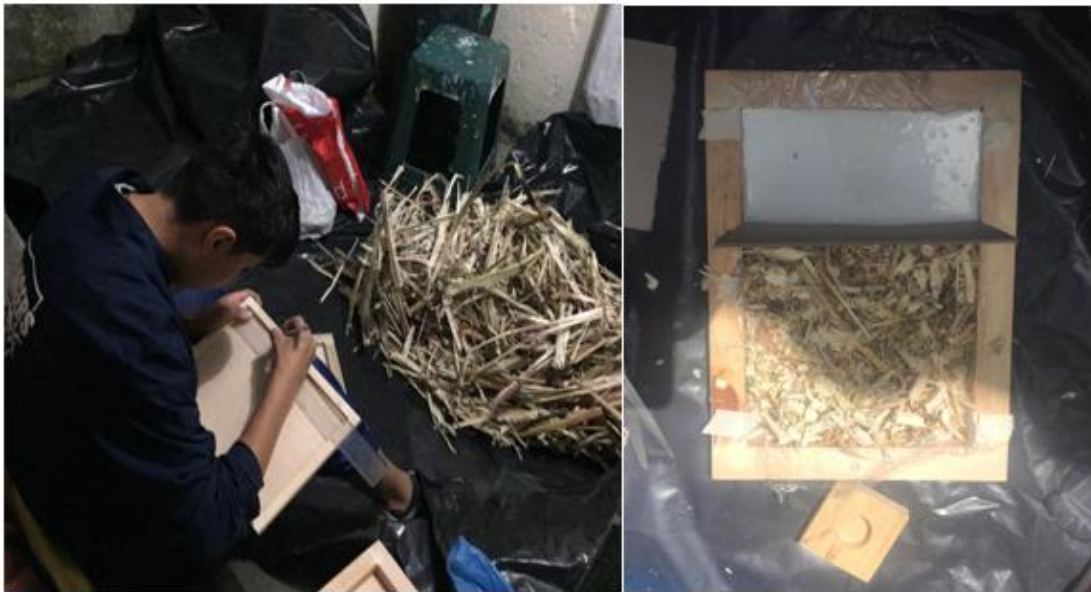
Figura 29. Proceso de elaboración de aglutinante de goma y fibra caña de maíz.
