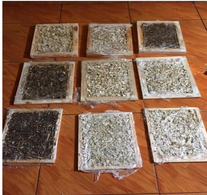
Figura 66. Paneles acústicos de fibra de caña de maíz, obtenidos del desarrollo del proyecto
