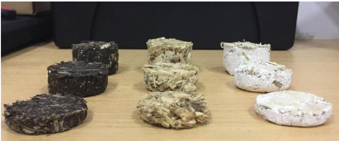
Figura 32. Muestras para la medición en el tubo de impedancia (bagazo maíz-barro, bagazo maíz-goma y bagazo maíz-yeso).
