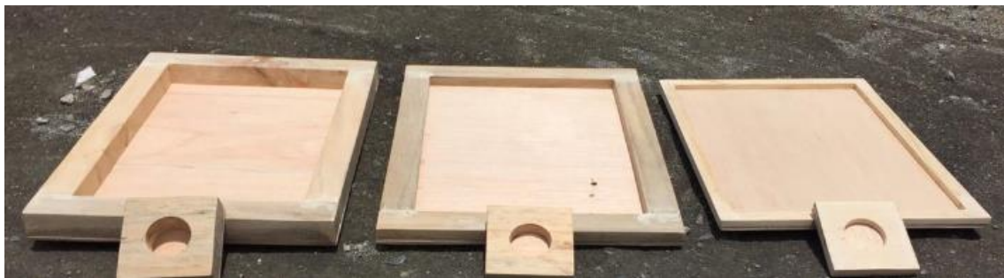
Figura 28. Moldes para los paneles de la fibra de caña de maíz. 6, 12 y 24mm.
