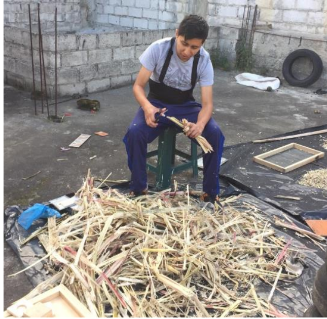
Figura 26. Proceso de corte milimetrado de la fibra para pasar al cedazo metálico.
