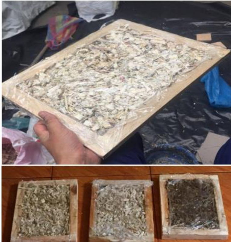
Figura 30. Resultado de los paneles de caña de maíz con sus respectivos aglutinantes (barro, goma y yeso).
