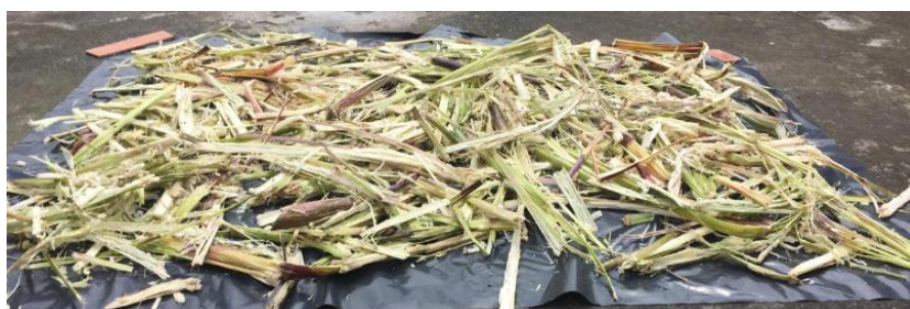
Figura 23. Proceso de secado de la fibra triturada expuesta a la intemperie por un lapso de dos días (48Hrs).
