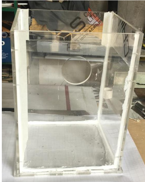
Figura 15. Fotografía de la finalización de construcción del tanque coagulador.
