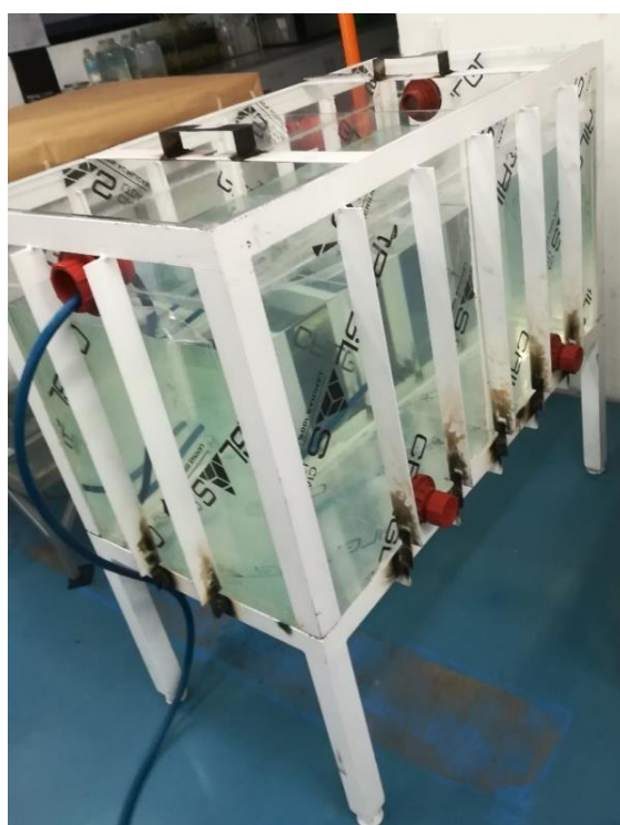
Figura 28. Fotografía de la prueba final del tanque floculador.
