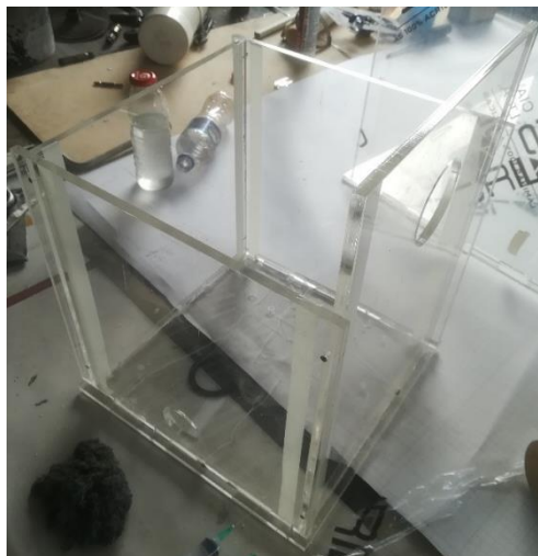
Figura 14. Fotografía del proceso de construcción del tanque coagulador.
