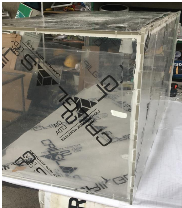
Figura 17. Fotografía de la finalización de construcción del tanque floculador.
