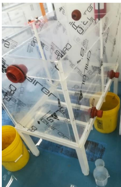
Figura 26. Fotografía de la primera prueba de estanqueidad de los tanques floculadores.
