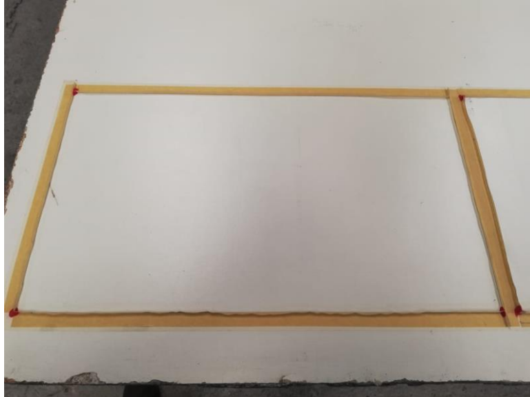
Figura 14. Molde listo para elaboración de los materiales compuestos.
