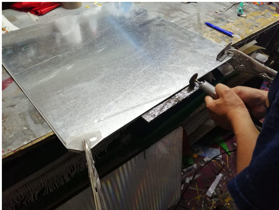
Figura 24. Corte de las probetas con ayuda de una plancha de acero.
