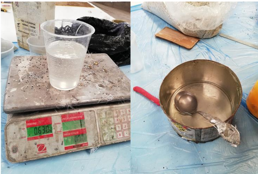
Figura 16. Pesaje de la resina y preparación de esta con MEK.
