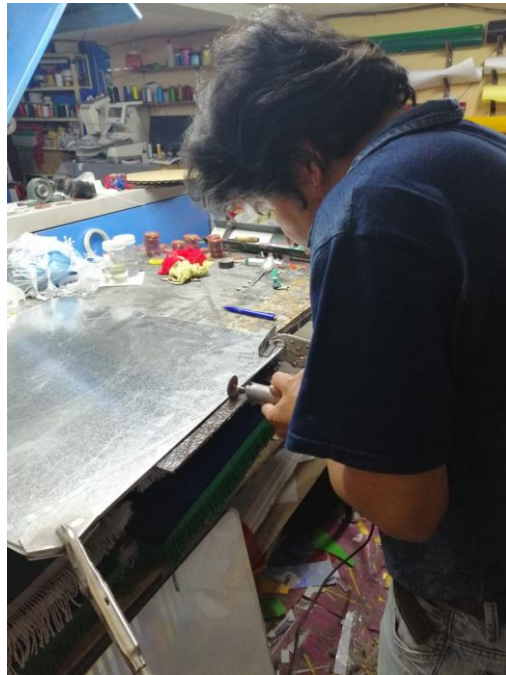
Figura 23. Corte de las probetas con ayuda de una plancha de acero.
