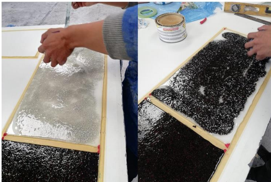
Figura 18. Vertido de la mezcla de los compuestos en el molde.
