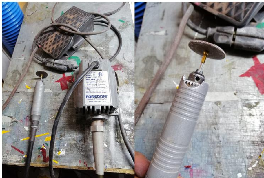
Figura 22. Herramienta de corte FOREDOM con adaptación de fresadora.
