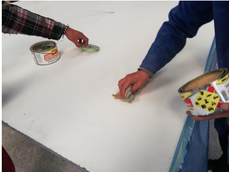
Figura 12. Aplicación de la cera desmoldante en la superficie de la mesa.
