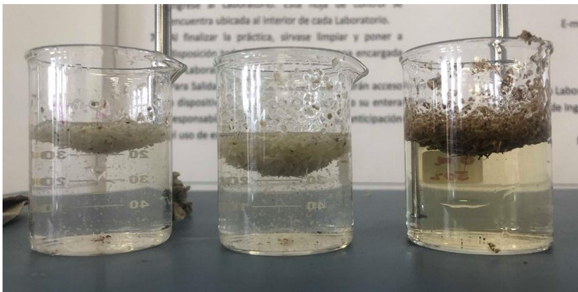
Anexo 4. Pruebas de flotabilidad del bagazo de caña de azúcar sin tratamiento, bagazo de caña de azúcar con cera de abeja y bagazo de caña de azúcar con cera de abeja y tratamiento térmico.
