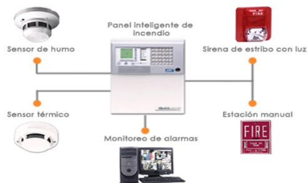
Figura 55. Esquema de funcionamiento de alarmas.
