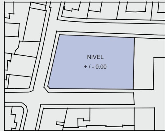
Debido a que existen solo dos cotas en el lote hacia la esquina inferior derecha, se nivelará todo el lote para trabajar en una sola plataforma.
