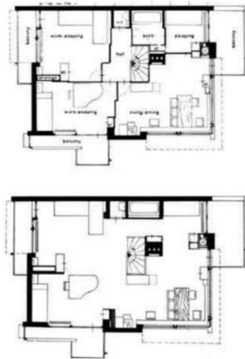
Figura 120. Gerrit Rietveld. Casa Rietveld Schroder, Utrecht (1924). Dos configuraciones posibles de la segunda planta.
