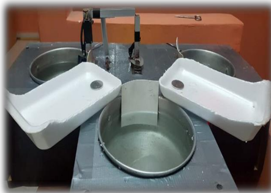
Figura 11. Máquina de termociclado
