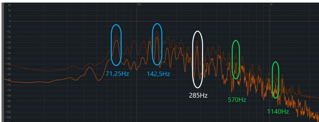
Figura 28. Frecuencia de 285 Hz encontrada en la pista, con octavas. Tomada de Ableton Live.
