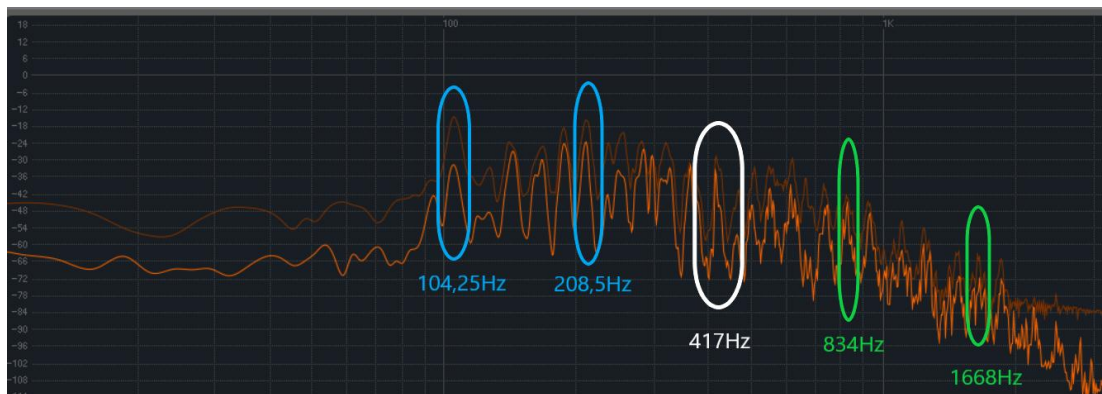
Figura 32. Frecuencia de 417 Hz y octavas altas y bajas en la pista. Tomada de Ableton Live .
