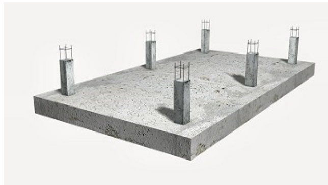
Figura 20. Estructura de una losa de cimentación.
