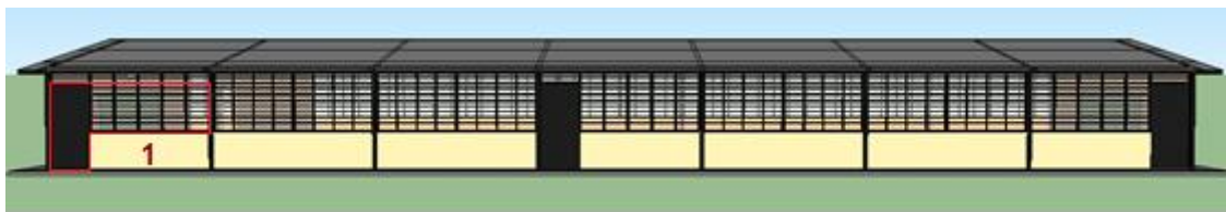
Figura 210. Fachada Este de pared a ser aumentada y sellada con bloque de 15cm.
