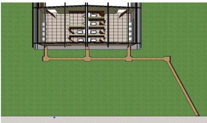
Figura 227. Zanjas para el desagüe.
