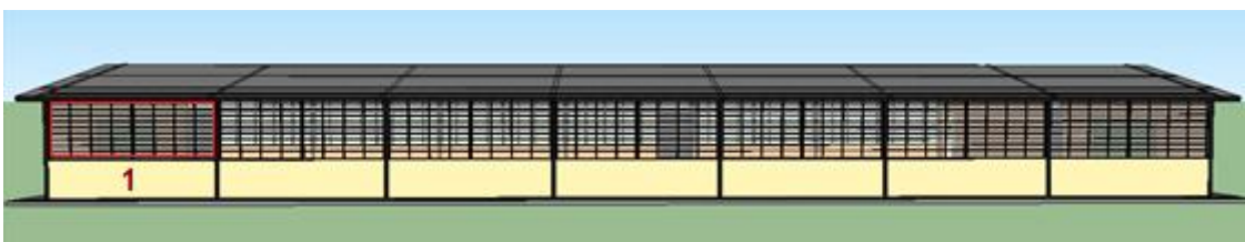
Figura 184. Pared a sufrir el corte de 1,175m en su estructura metálica.
