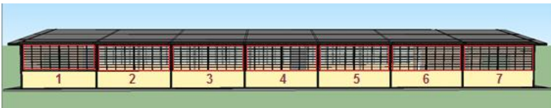
Figura 178. Localización en fachada Oeste de 7 ventanales de 1,485 x 3,88m.
