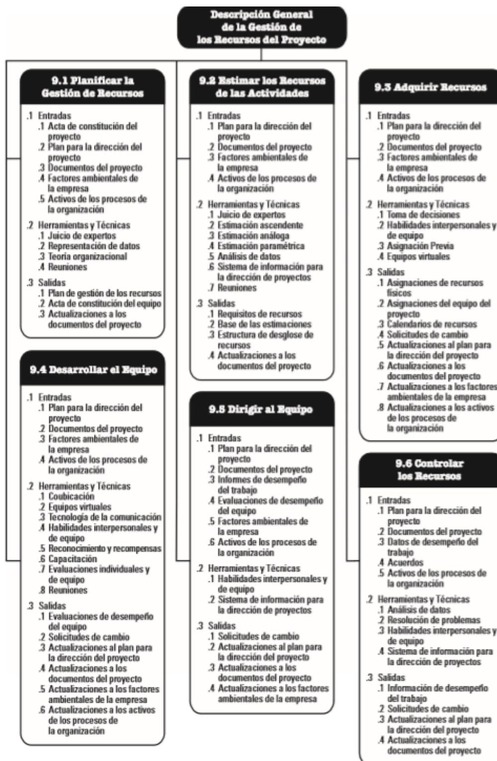
Figura 16. Gestión de los recursos del proyecto. Tomado de (Project Management Institute, Inc. PMI, 2017).
