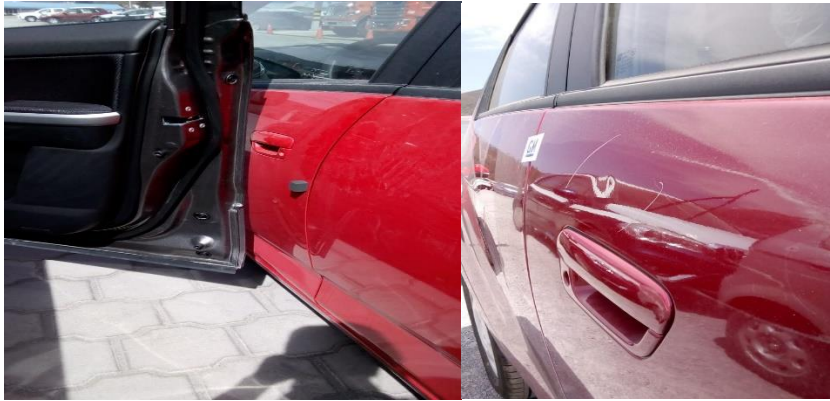
Figura 19. Daños por golpes de Puertas.
