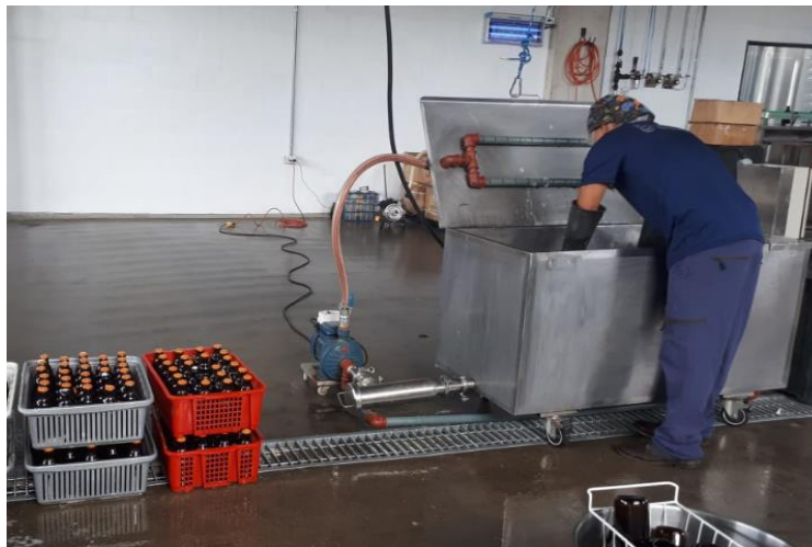
Figura 10. Pasteurizador de cerveza, Santana Brewing Company S.A.
