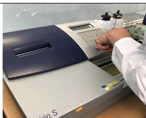
Paso 10. Configuración del lector de ELISA para leer las placas a una Densidad Óptica de 450nm.
