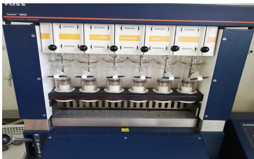
Figura 13. Equipo Soxhlet para extracción de materia grasa
