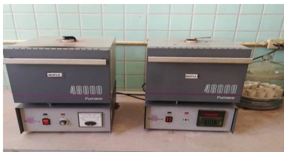
Figura 12. Calcinación en la mufla
