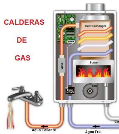
Figura 18. Sistema de calefacción caldera a gas
