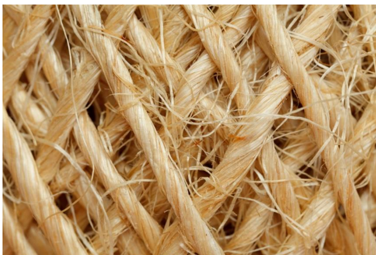
Figura 8. Detalle fibra de cabuya. Hilares de cabuya entrelazados aleatoriamente. Tomada de Muscio, E., 2017.
