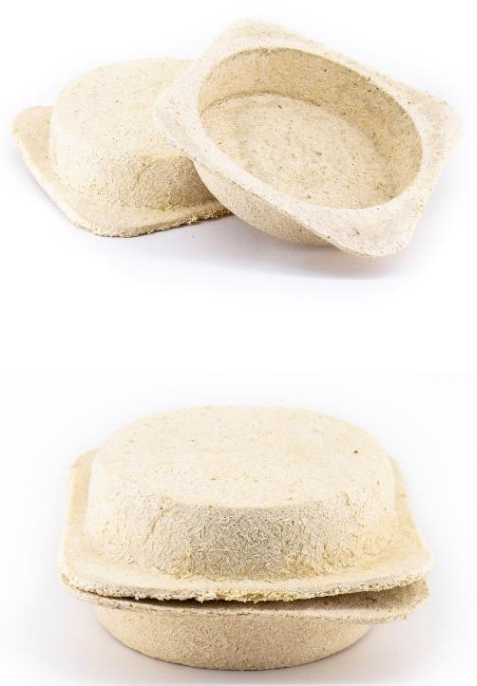
Figura 52. Exploración 15 Bagazo y engrudo de harina. Propuesta final
