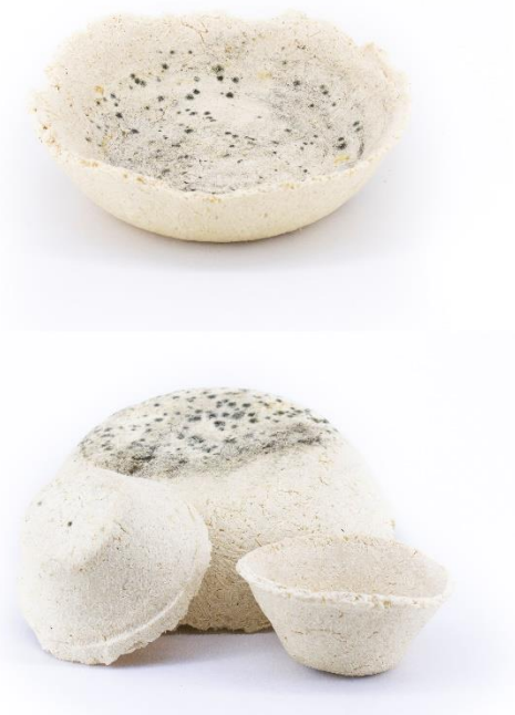
Figura 49. Exploración bagazo y engrudo. Presencia de hongos por mal tratamiento de secado
