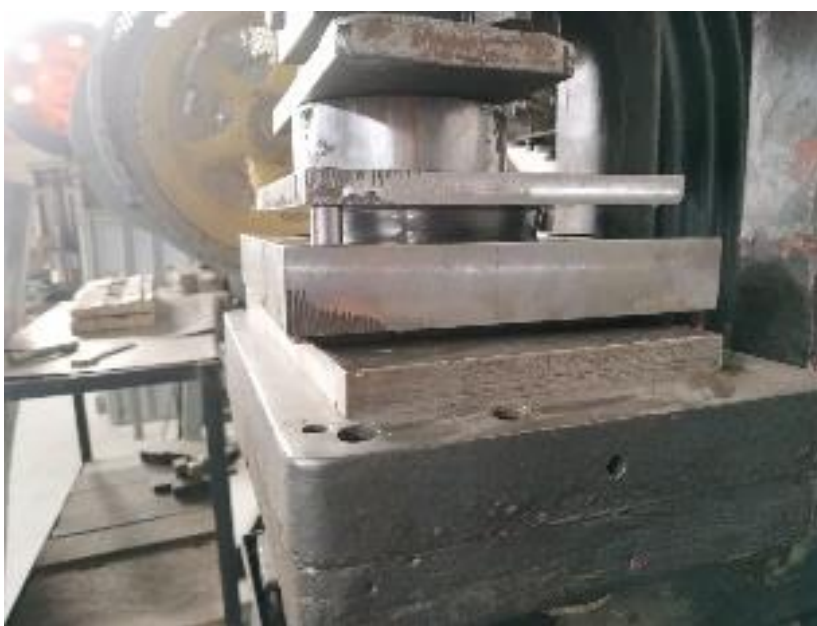
Figura 53. Prensado de material compuesto en matriz de acero
