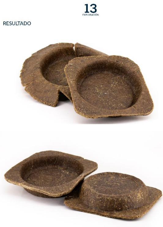
Figura 50. Exploración 13 Cáscara de plátano y saponina. Matriz acero
