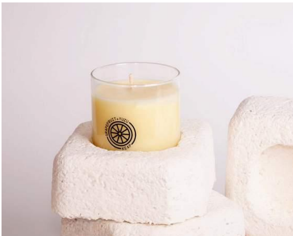
Figura 17. Formas moldeadas. Tecnología MycoComposite aplicada como material de amortiguamiento. Tomada de Ecovative, 2019
