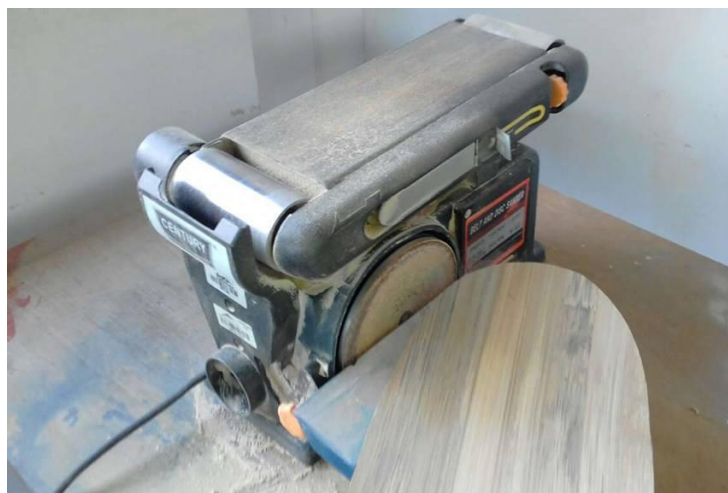
Figura 150. Lijado de cantos.
