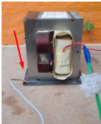
Figura 130. Transformador conexión alto voltaje.
