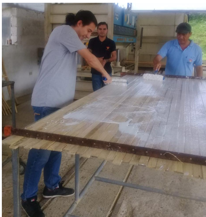
Figura 136. Encolado de latillas.
