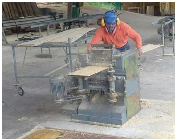
Figura 140. Cepillado de tableros.
