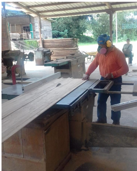
Figura 139. Corte del tablero.
