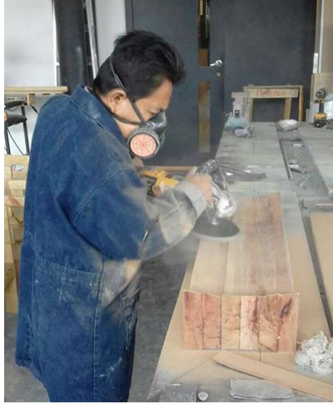
Figura 127. Lijado del molde con amoladora.
