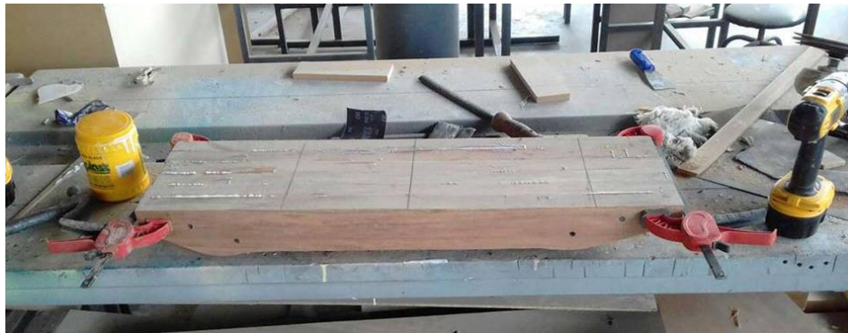
Figura 123. Ensamblaje parte superior del molde.
