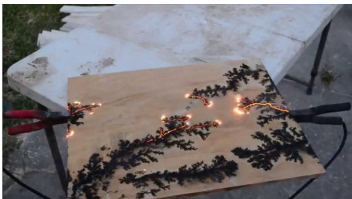
Figura 88. Proceso de grabado mediante alta tensión
