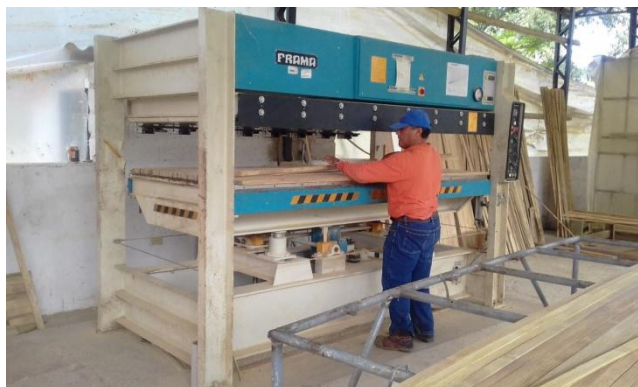
Figura 137. Prensado de latillas encoladas.
