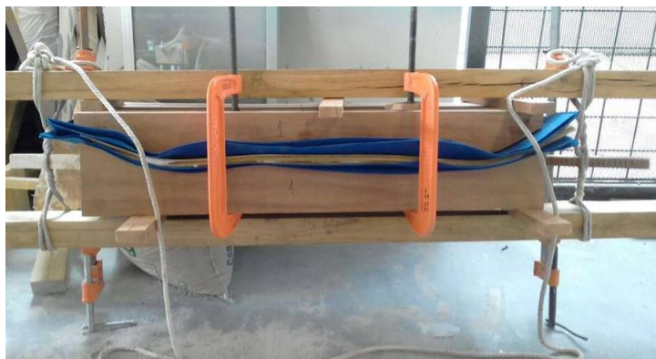
Figura 146. Distribución de las prensas.
