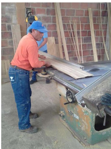
Figura 142. Corte al largo requerido.
