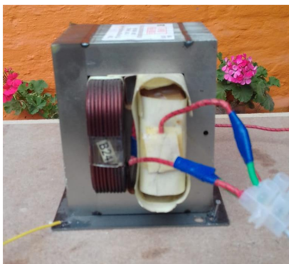
Figura 129. Transformador primera conexión.
