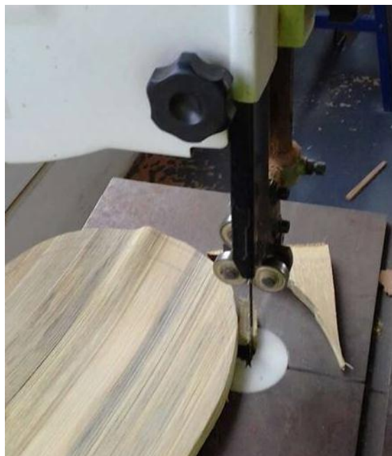
Figura 149. Corte del contrachapado obtenido.
