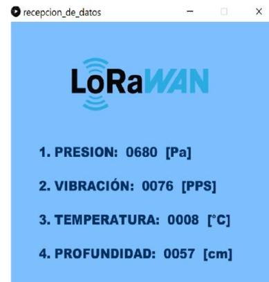
Figura 33. Prueba 2 transmisión a distancia de 400 m.
