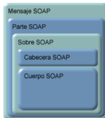
Figura 11. Estructura de un mensaje SOAP.
