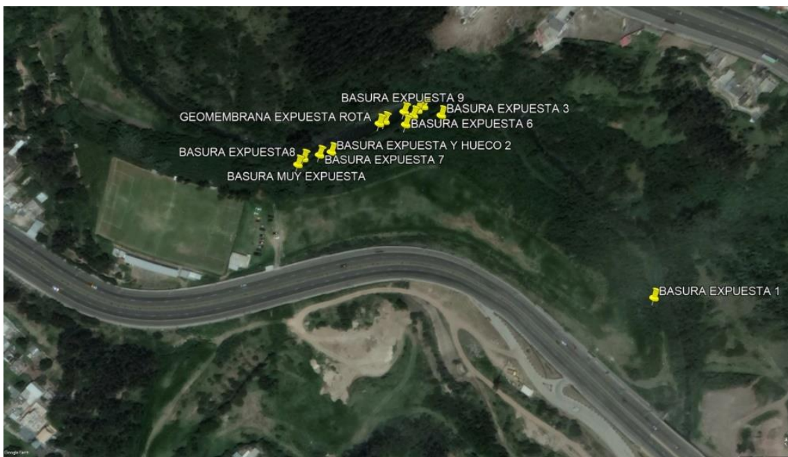
Figura 4. Puntos del ex botadero que presentan ruptura de geomembrana.
