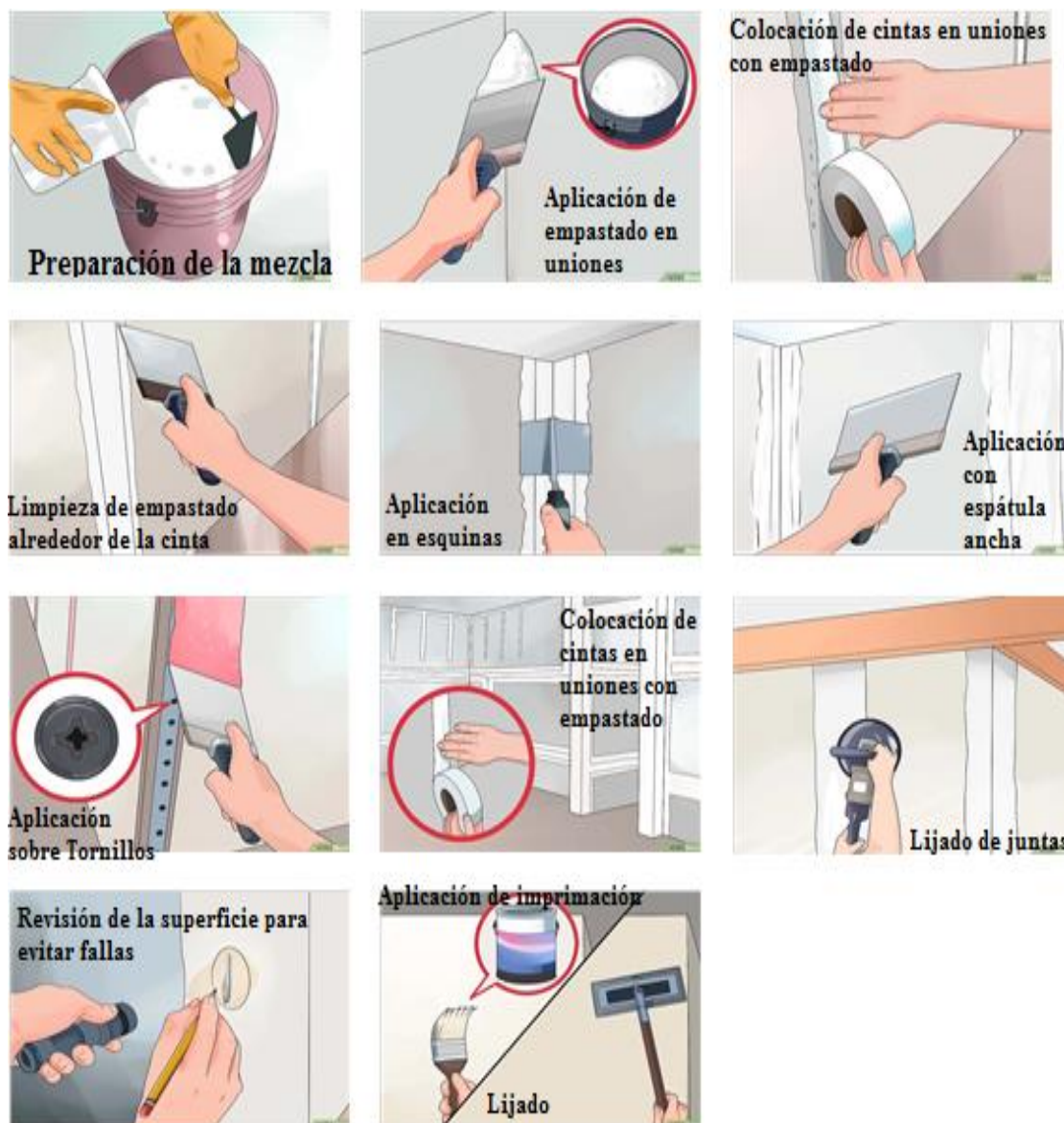
Figura 84. Tratamientos de las juntas
