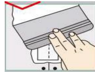
Aplicación de masilla
