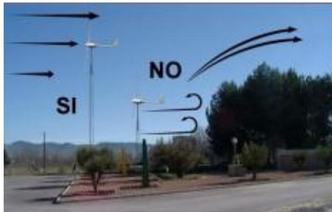
Figura 108. Influencia de los obstáculos en el aerogenerador. Tomado de: (BORNAY.COM©1970-2017, Aerogenerador Wind 25.3+ :BORNAY, 2017)
