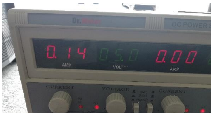
Figura 47. Consumo eléctrico del nodo auxiliar.
