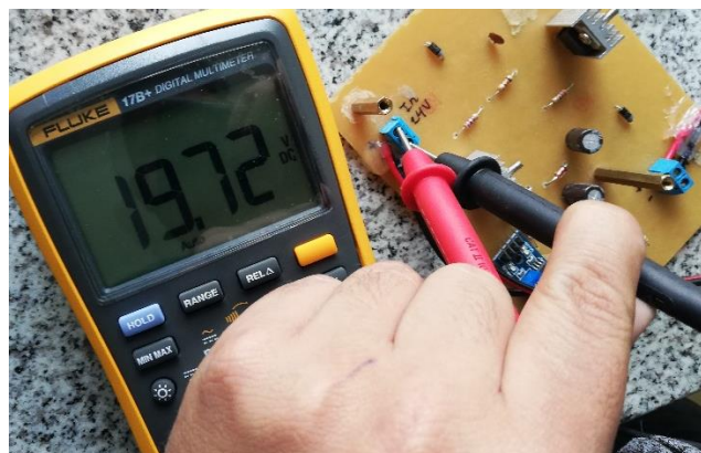
Figura 37. Tensión eléctrica generada por el panel solar.
