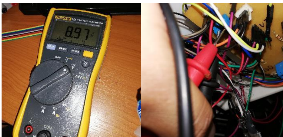
Figura 42. Tensión en el pin que alimenta al microcontrolador.
