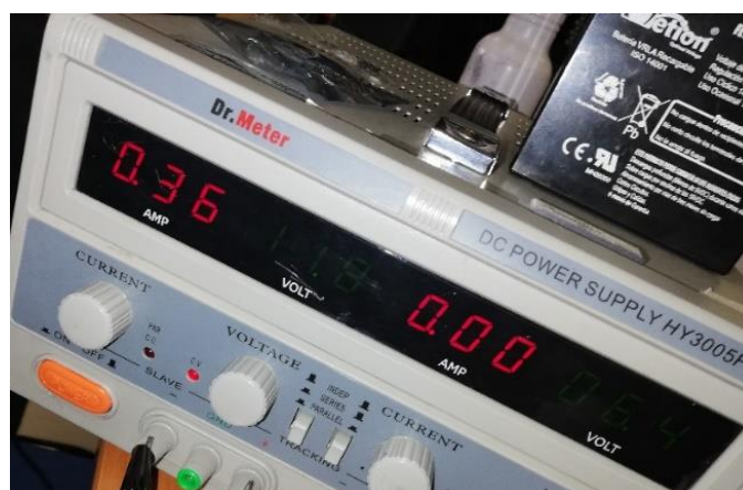
Figura 45. Consumo eléctrico del nodo principal con el actuador fuera de funcionamiento.
