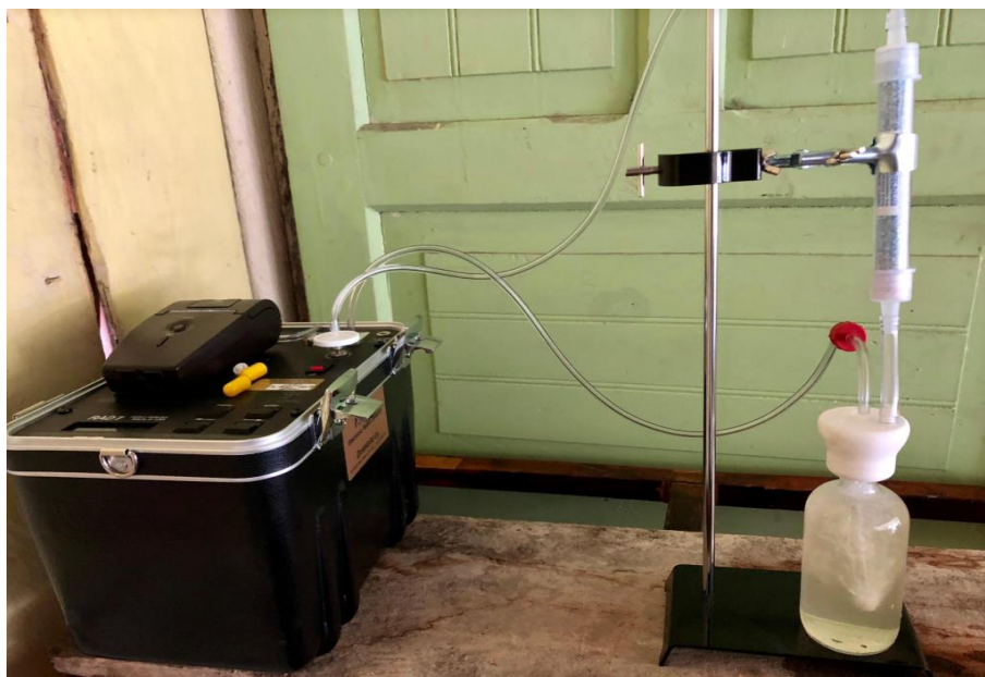
Figura 23. Medición de radón mediante el equipo RAD7 y su accesorio H 2 O.
