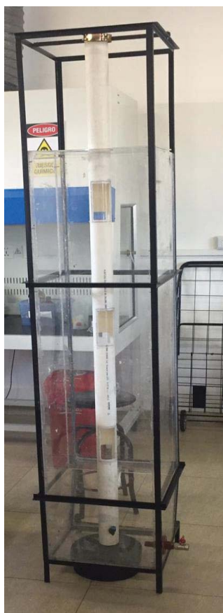
Figura 6. Tanque de recolección, con estructura metálica y Airlift contruidos.
