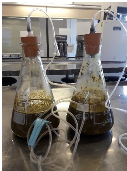
Figura 17. Sistemas armados para la obtención del inóculo.
