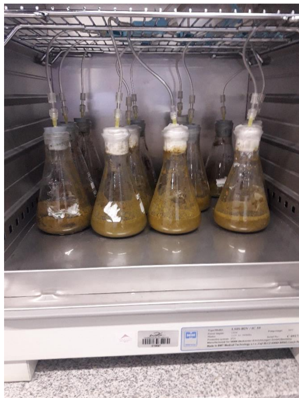
Figura 18. Sistemas de biodigestión dentro de la incubadora.
